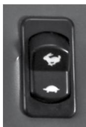
La velocità più elevata è destinata per i viaggi più lunghi dove l'alta forza di trazione non è necessario.
