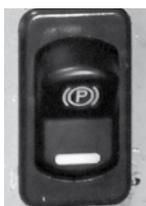
Il freno di stazionamento si attiva automaticamente quando il motore è fermo. Il freno può essere rilasciato solo quando il motore è in funzione e non vi è la pressione idraulica nel sistema.
