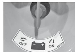
La disconnessione dello staccabatterie interrompe la corrente tra batteria e il resto del sistema elettrico. Spegner sempre corrente principale quando la macchina non viene utilizzato per un periodo di tempo o durante la manutenzione della macchina.
