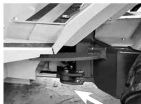
Il blocco del telaio si trova sopra lo snodo, sotto la base del sedile, ed è fissato con un bullone.
