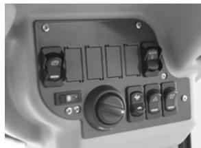
Su CAB DLX alcune delle opzioni indicate in dettaglio a pagina 14 si trovano sul pannello di controllo in alto a destra. Il pannello include interruttori per il freno di stazionamento, leva di velocità, ventola, A / C, piastra adattatrice per accessorio, segnali di emergenza, e lampeggiate
