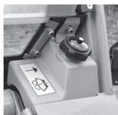
Il serbatoio e il tappo serbatoio del tergicristallo su macchine con cabina LX e DLX si trovano all'esterno della cabina, di fronte al parabrezza a sinistra.
