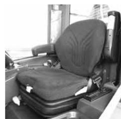
Il sedile è dotato di riscaldamento. L'interruttore del riscaldatore si trova sulla parte sinistra dello schienale. Sotto di esso si trova la regolazione del supporto lombare.
