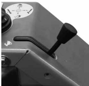
L'acceleratore a mano può essere utilizzata per controllare la velocità del motore anche durante la marcia. La regola di base è: usare giri più bassi per il lavoro più leggero e giri più elevati per il lavoro più pesante che richiede velocità di marcia più alta.
